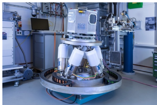
PETRA IIIのP07ビームラインのEH3実験装備にあるヘキサポッド：チタン アルミナイドレーザー溶接をするために、真空チャンバーの位置を決めます。(画像: PI / Helmholtz-Zentrum Geesthacht)
