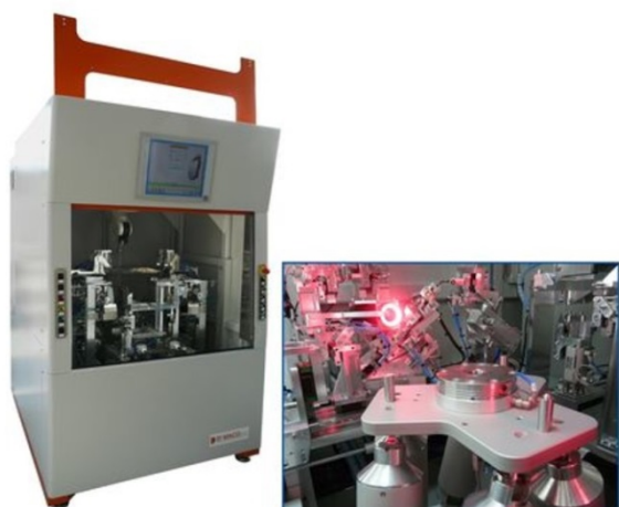
3次元測定器DM401シリーズは、ヘッドランプの位置決めにH-820ヘキサポッドを採用しています (画像: Dymaco Group)
