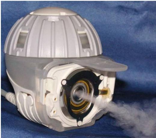
Abb. 8 Die Aerosolerzeugung im Verneblerkopf der eFlow® rapid Electronic Nebulizer Serie setzt Piezoaktoren zur Erzeugung von Ultraschallschwingungen ein. (Pari Pharma GmbH)
