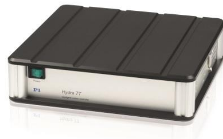
Abb. 33 SMC Hydra Motorsteuerung mit integriertem Encoder-Interface-Modul DeltaStar Eco. 3000 Mikroschritte je Vollschrift, Auswertung von analogen Positionssignalen (sin/cos, 1 V_{pp} )
